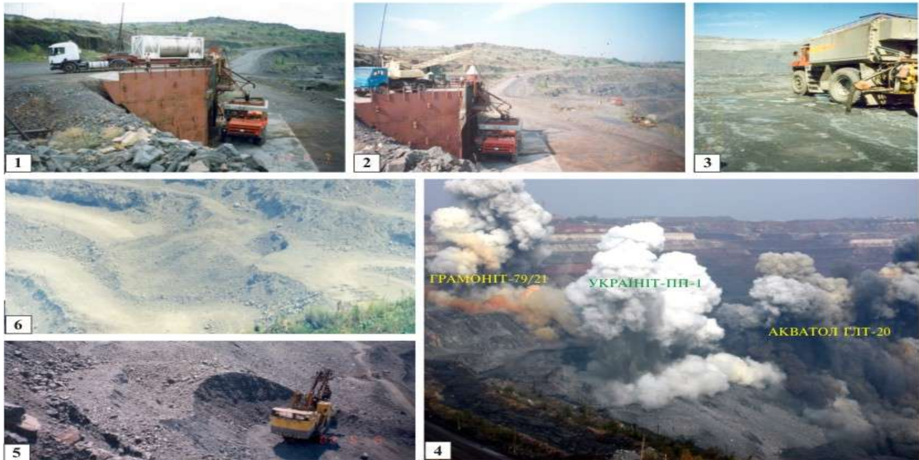
РИС. 2 ПРЕЦЕС ВИГОТОВЛЕННЯ УКРАЇНІТУ-ПП-1 ТА РЕЗУЛЬТАТИ ЙОГО ВИКОРИСТАННЯ НА ІНГУЛЕЦЬКОМУ ГЗК
